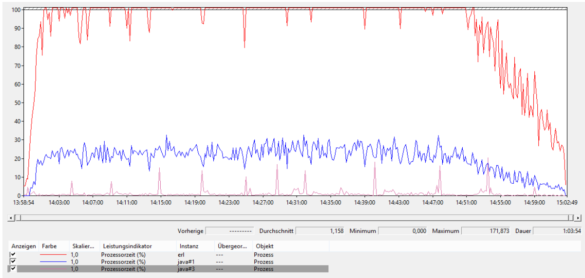
Abbildung 40 Lasttest #2: Prozessorauslastung durch ODS (java#1), CEPS (java#3) und CouchDB (erl). (Quelle: Eigene Darstellung).
