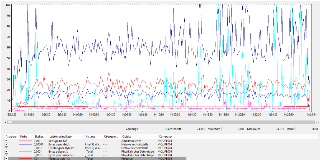
Abbildung 34 Lasttest #1: Gesamtressourcenverbrauch der Maschine A: Prozessorauslastung, Speicherverbrauch, Netzwerkdurchsatz und Festplattendurchsatz. (Quelle: Eigene Darstellung).
