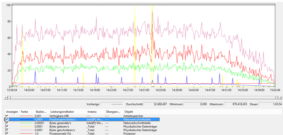
Abbildung 39 Lasttest #2: Gesamtressourcenverbrauch der Maschine A: Prozessorauslastung, Speicherverbrauch, Netzwerkdurchsatz und Festplattendurchsatz. (Quelle: Eigene Darstellung).
